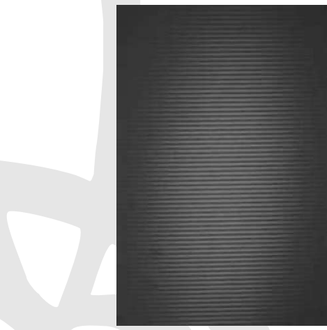
Bild 2: Interferenzstreifenmuster im LDV-Messvolumen. Figure 2: Pattern of interference fringes in the LDV measuring volume.
