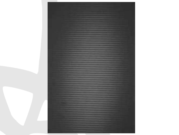
Bild 2: Interferenzstreifenmuster im LDV-Messvolumen. Figure 2: Pattern of interference fringes in the LDV measuring volume.
